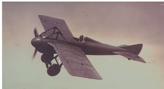
**Figura 4:** M. Prévost sobre el Deperdussin Monocoque, ganador de la Copa Gordon-Bennett en 1912 al recorrer 200 km en 59 min 45 s. Su construcción le proporcionaba un diseño aerodinámicamente limpio que le permitió aumentar el récord mundial de velocidad a 210 km/h en 1913. (Fotografía de dominio público)
