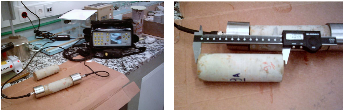
FIGURA – 52: EQUIPO PARA LAMEDICIÓN DE LA VELOCIDAD DE ONDAS EN MUESTRAS DE LA CV – 13. (FUENTE: ELABORACIÓN PROPIA).
