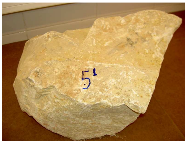
FIGURA – 42: MUESTRA REPRESENTATIVA DE LAS CALIZAS DEL DESMONTES Nº 8. (FUENTE: ELABORACIÓN PROPIA).
