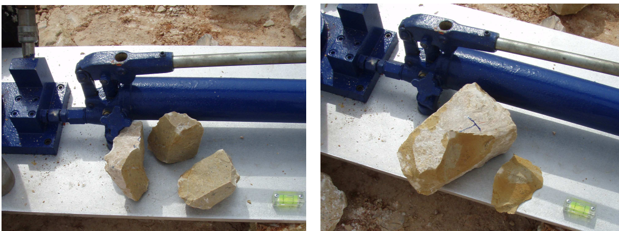
FIGURA – 48: EJEMPLO DE ROTURA VÁLIDA (IZQUIERDA) Y NO VÁLIDA (DERECHA). (FUENTE: ELABORACIÓN PROPIA).
