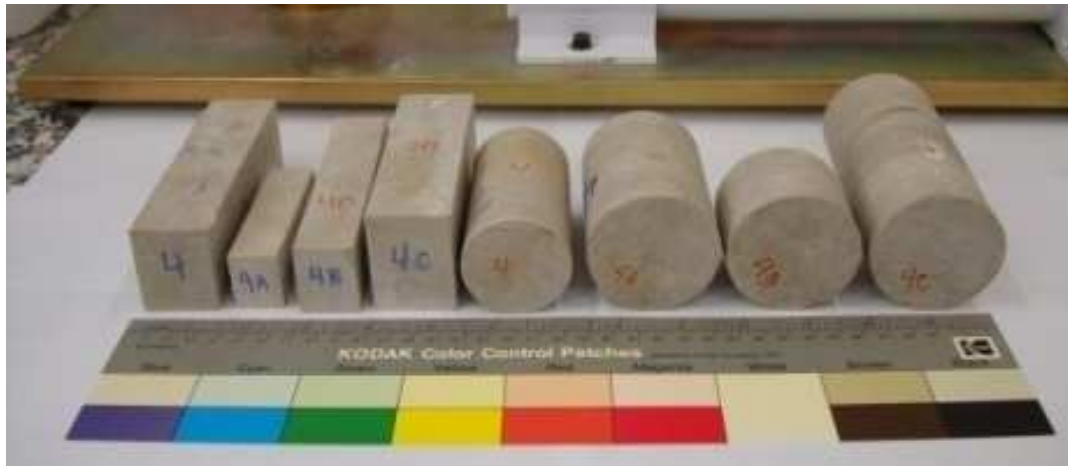
FIGURA – 44: EJEMPLO DE MUESTRAS CILÍNDRICAS Y EN BLOQUE REGULAR TALLADAS EN LA 2ª CAMPAÑA DE ENSAYOS CON MUESTRAS DE LA CV - 13. (FUENTE: ELABORACIÓN PROPIA).
