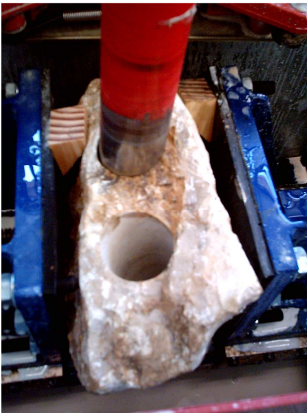
FIGURA – 43: SALA DE TALLADO DE MUESTRAS EN EL LABORATORIO. (FUENTE: ELABORACIÓN PROPIA).
