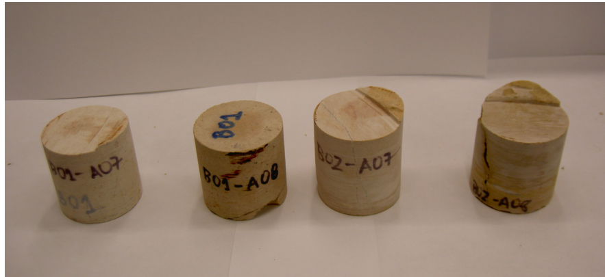
FIGURA – 83: ROCAS DE LA PLANTA DE SIERRA GORDA, CON DIFERENTES CONTENIDOS DE HUMEDAD. FUENTE: ELABORACIÓN PROPIA.
