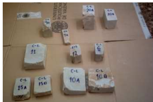
FIGURA – 40: EJEMPLO DE FRAGMENTOS CON FORMA DE BLOQUE REGULARES PARA SER ENSAYADOS EN LA 2ª TANDA O TALLADOS PARA LA 3ª TANDA. (FUENTE: ELABORACIÓN PROPIA).
