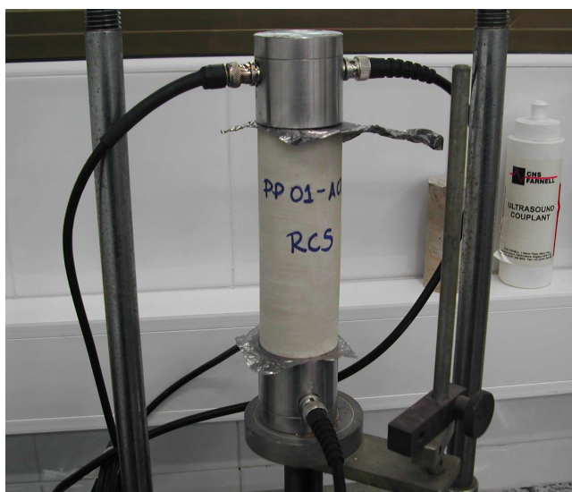
FIGURA – 88: EJEMPLO DE LA MEDICIÓN DE LA VELOCIDAD DE ONDAS EN MUESTRAS DE LA COMUNIDAD VALENCIANA. FUENTE: ELABORACIÓN PROPIA.
