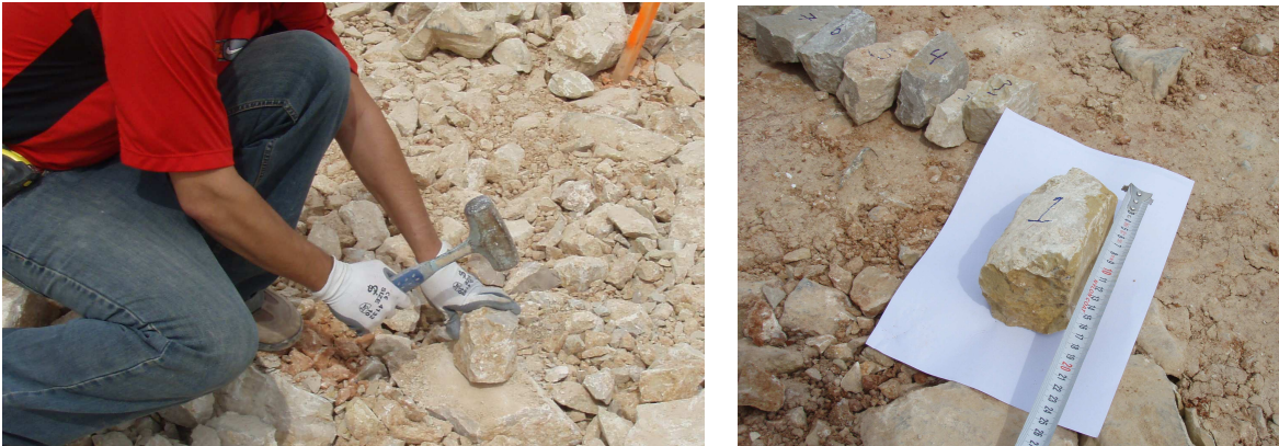
FIGURA – 46: TALLADO DE LAS PROBETAS EN CAMPO EN LA CV - 13. (FUENTE: ELABORACIÓN PROPIA).
