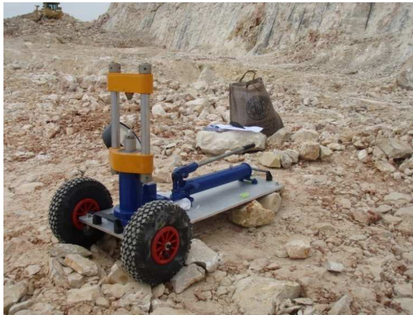
FIGURA - 29: MÁQUINA EN CAMPO PARA EL ENSAYO DE CARGA PUNTUAL (DEPARTAMENTO DE INGENIERÍA DEL TERRENO -UPV).
