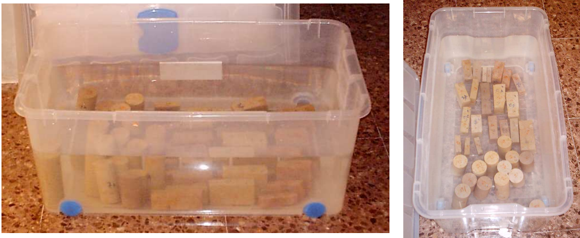
FIGURA – 54: ENSAYOS DE INMERSIÓN ESTÁTICA CON MUESTRAS DE LA CV – 13. (FUENTE: ELABORACIÓN PROPIA).
