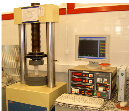
FIGURA – 50: ENSAYO DE RCS EN LABORATORIO CON MUESTRAS DE LA CV – 13. (FUENTE: ELABORACIÓN PROPIA).
