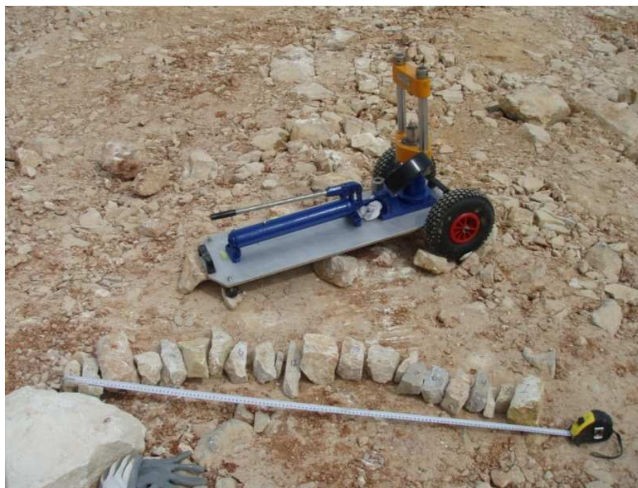
FIGURA – 38: MUESTRAS PARA EL ENSAYO PLT EN CAMPO PROCEDENTES DEL DESMONTE Nº 8. (FUENTE: ELABORACIÓN PROPIA).
