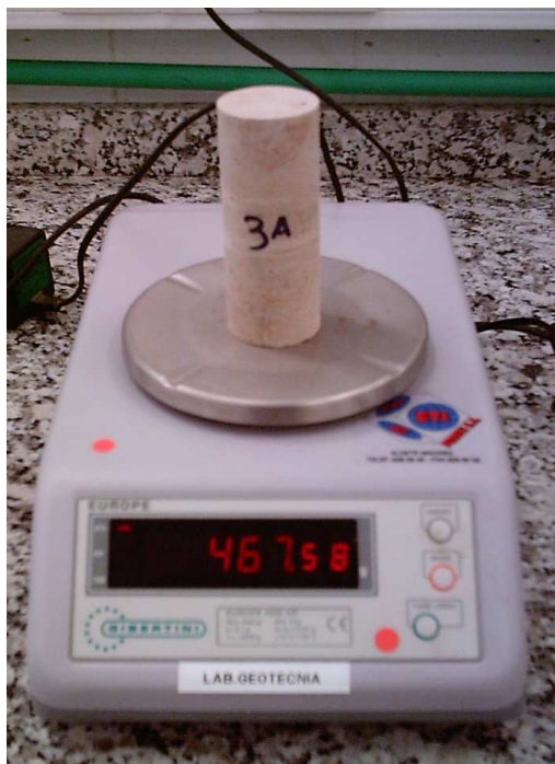
FIGURA – 55: PESO DE LAS MUESTRAS SECAS Y SATURADAS CON LA SUPERFICIE SECA (IZQUIERDA) Y SATURADAS EN BALANZA HIDROSTÁTICA (DERECHA) DE MUESTRAS DE LA CV – 13. (FUENTE: ELABORACIÓN PROPIA).
