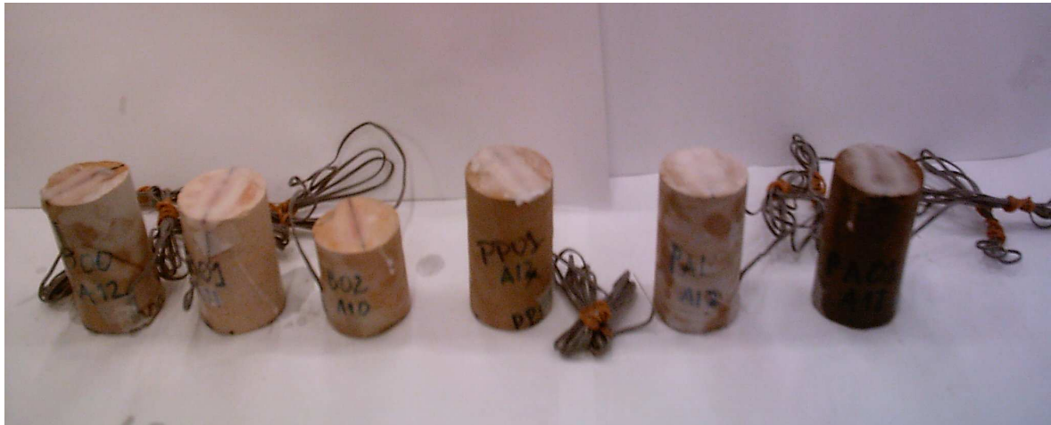
FIGURA – 86: ROCAS DE CUATRO PUNTOS DE LA COMUNIDAD VALENCIANA, CON GALGAS EXTENSIOMETRICAS. FUENTE: ELABORACIÓN PROPIA.
