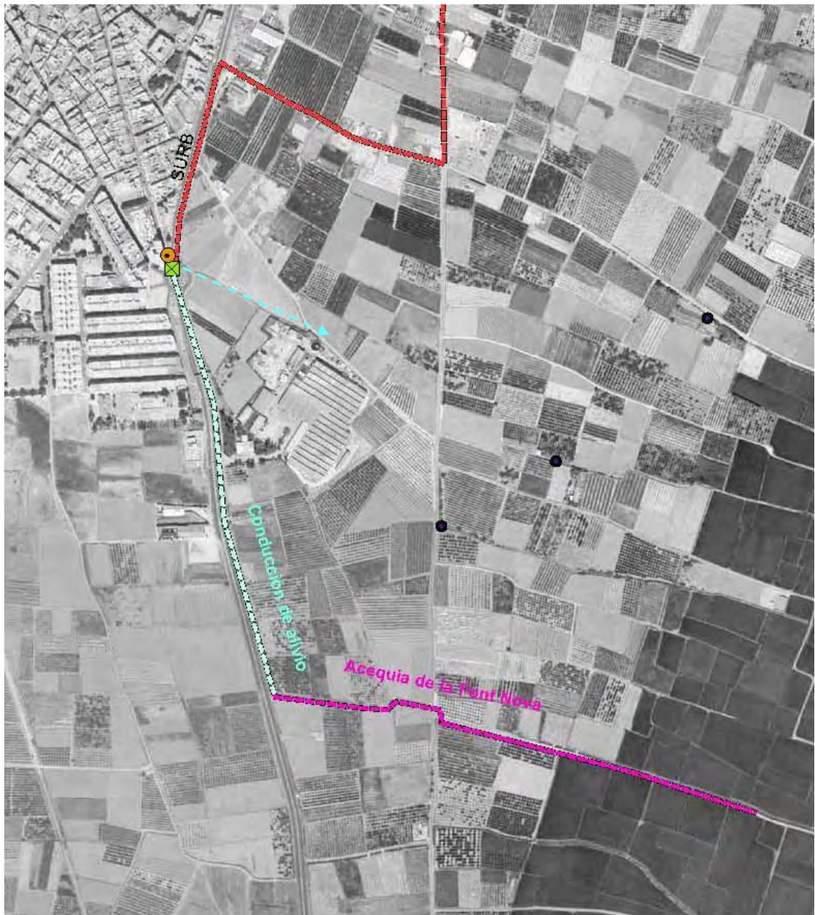
Figura 2-52. Esquema del aliviadero Silla Sur a la acequia de la Font Nova con el punto de descarga identificado en verde. El punto de conexión de la red municipal al colector Oeste se señala en naranja.
