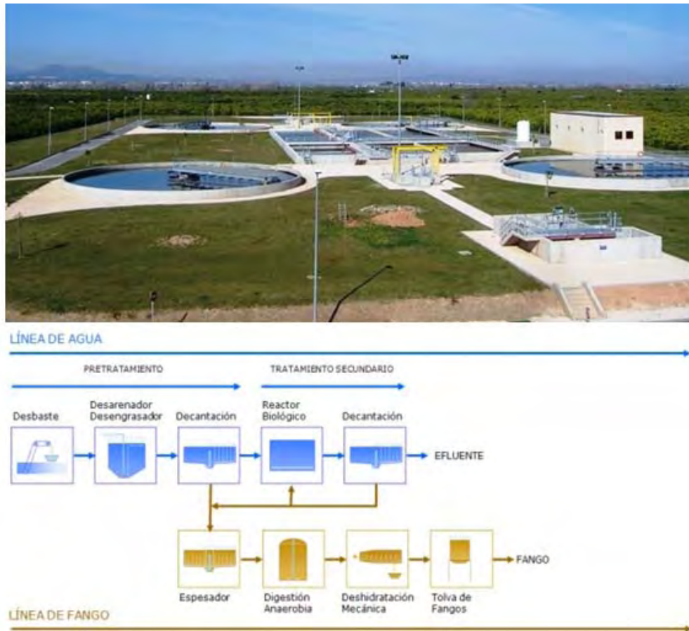
Figura 2-20. Fotografía y esquema del funcionamiento de la EDAR de Ribera Alta I
