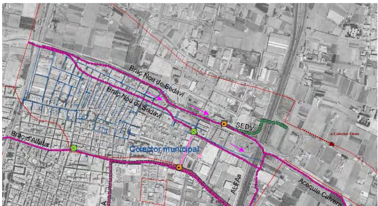
Figura 2-29. Esquema del funcionamiento del Braç Nou de Sedaví. Aliviaderos en verde. Conexión al colector Oeste en naranja.
