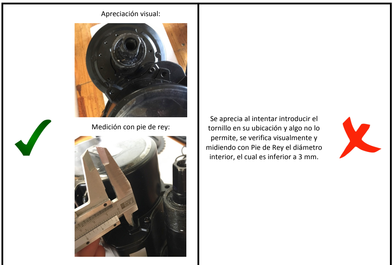
Figura 11 Exceso de pintura en orificios (Código EPO)
