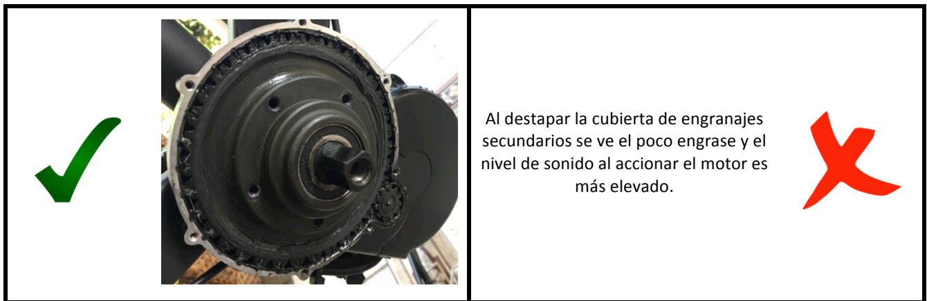
Figura 10 Engrase insuficiente (Código EI)
