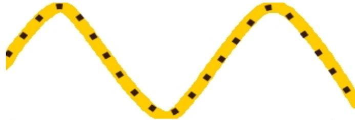
Figura 3: Señal muestreada sobrepuesta a la señal analógica original.
