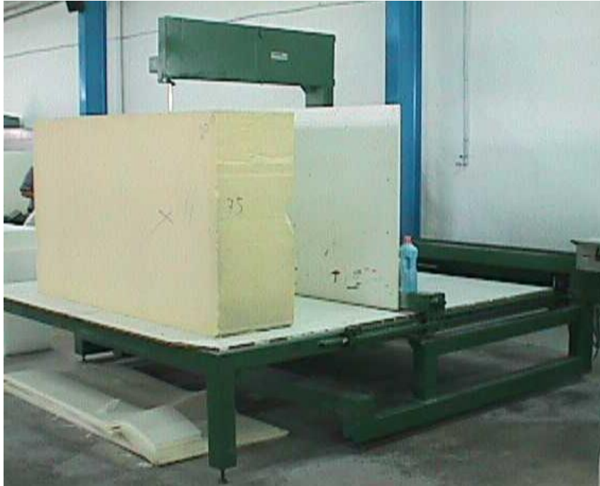
Ilustración 14 Laminado de poliéster.
