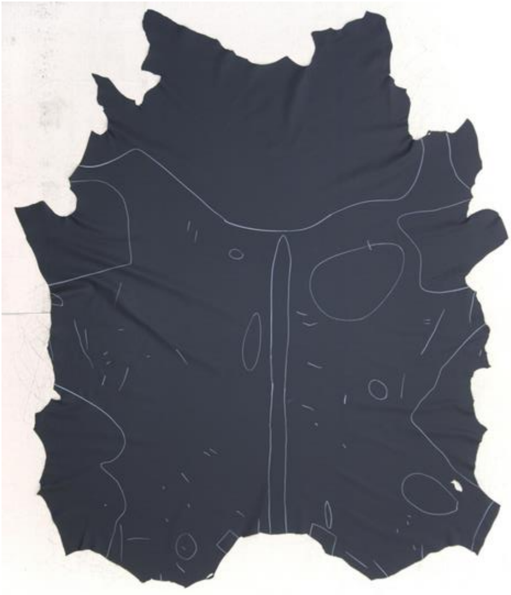
Ilustración 1 Piel con Defectos Identificados
