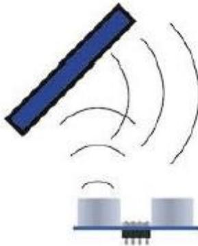
Figura 1: Error de medición del sensor ultrasónico.
