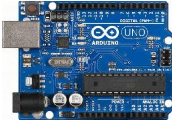
Figura 7: Placa Arduino UNO.
