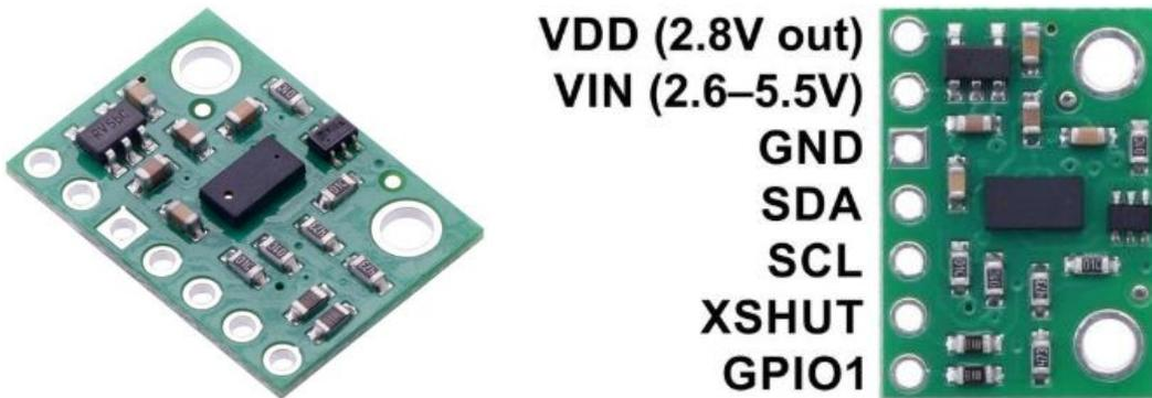
Figura 12: Sensor VL53L0X integrado por Polulu.
