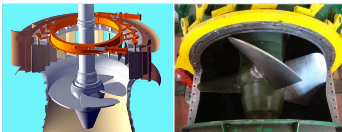
Imagen 21: Turbina Kaplan. Mini-centrales hidroeléctricas, Ministerio de Industria, turismo y comercio.
