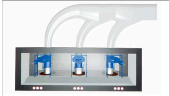
Imagen 16: Trifurcación de la tubería. Libro La presa de Tous.
