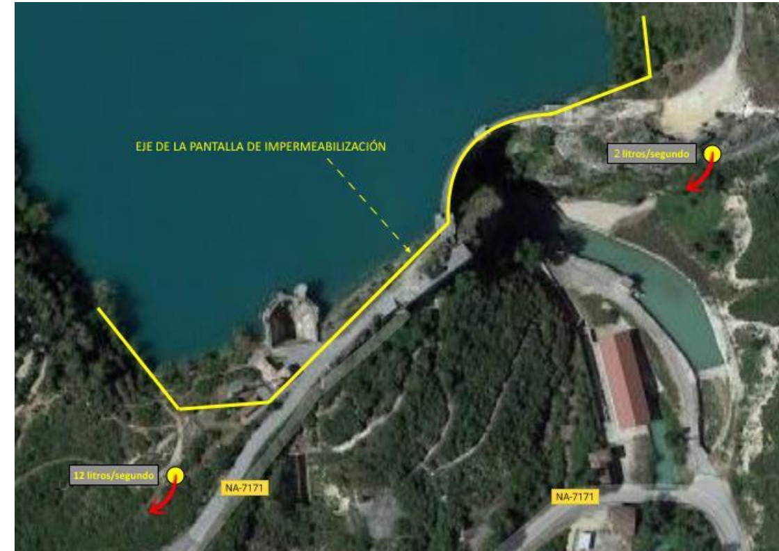
Figura 13. Eje de la pantalla. Fuente: Propia
