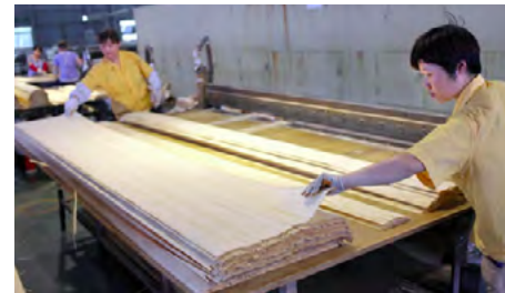
Trabajadores de la empresa Mosso preparando bambú laminado Fuente: moso.eu
