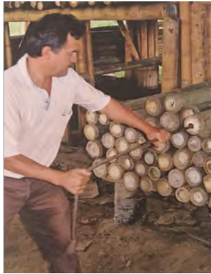
Agujereado de las paredes de los nudos
