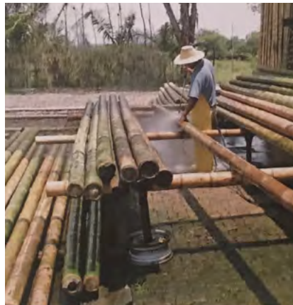
Limpieza de las cañas de bambú con agua a presión
