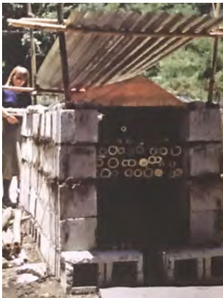
secado de las cañas mediante hornos
