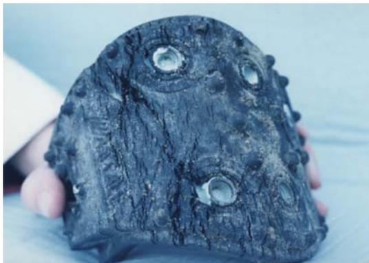
*Fig. 11.2. Suela de PU defectuosa debido a un proceso de hidrólisis. Las variaciones de los componentes o de las condiciones del proceso de curado del PU provocan drásticas consecuencias en el producto final.*
