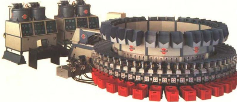
*Fig. 11.1. Máquina para fabricar y moldear las suelas hechas de PU. En cada uno de los moldes se inyecta la mezcla y se cierra, produciéndose en su interior la reacción química que produce el PU sólido.*
