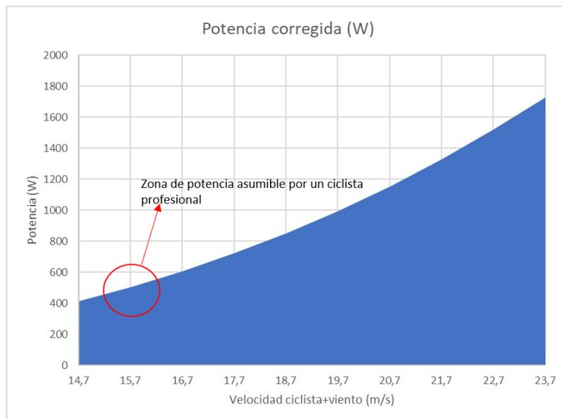
Figura 4.10: Evolución cúbica de la potencia con la velocidad resultante.
