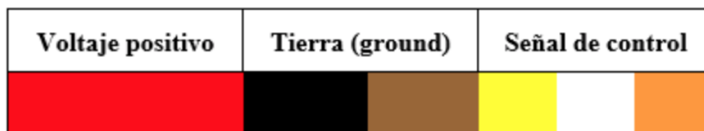
Figura 3.12: Colores que poseen los cables del servo, varían dependiendo del fabricante
