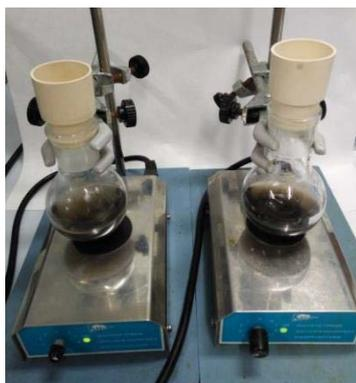
**Figura 3.6.** Montaje experimental para la preparación de la disolución de GO y SGO.
