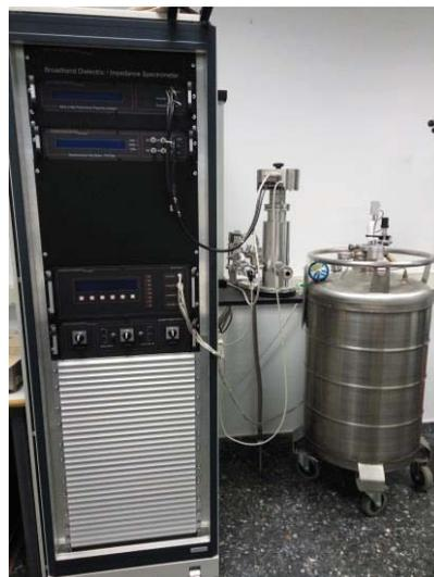
**Figura 3.11.** Espectrómetro dieléctrico de banda ancha Novocontrol.
