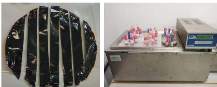
**Figura 3.13.** Membrana recortada para introducir en tubos de ensayo y montaje en baño isoterma Selecta Unitronic Bath con tubos de ensayo sumergidos en su interior.
