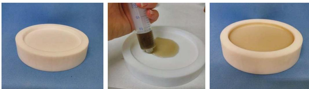
**Figura 3.7.** Proceso de vertido para la obtención de membranas.
