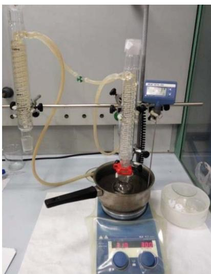
**Figura 3.5.** Montaje experimental para la preparación de la disolución de PVA.
