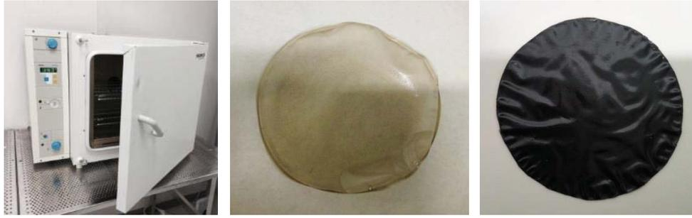
**Figura 3.8.** Estufa de convección Heraeus UT-6060 y apariencia de una membrana antes y después del proceso de entrecruzamiento.
