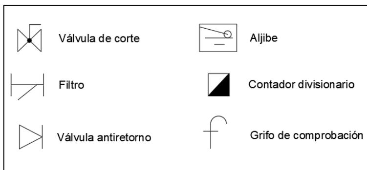
Ilustración 5: Leyenda del esquema de la instalación interior general
