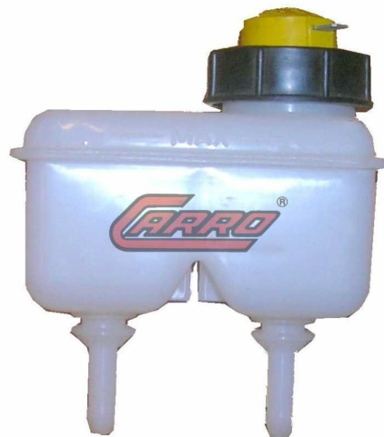
Figura 40. Depósito de líquido con dos salidas independientes
