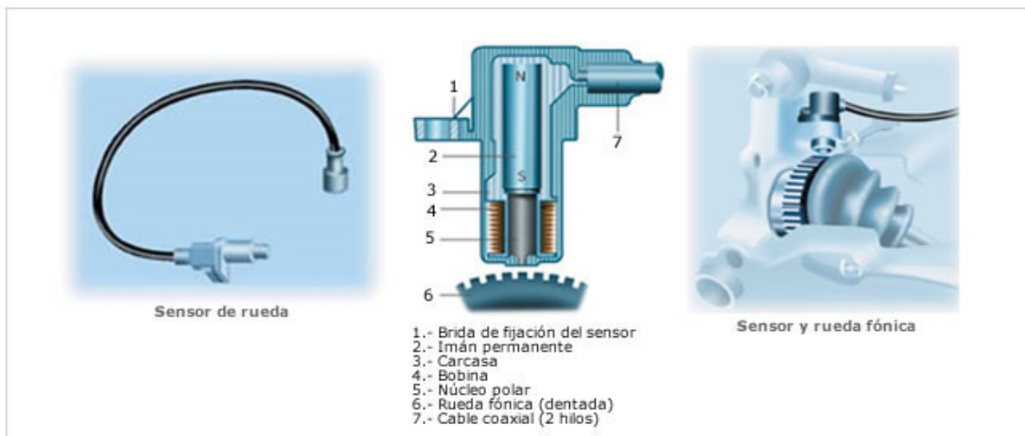
Figura 45. Esquema sensor inductivo
