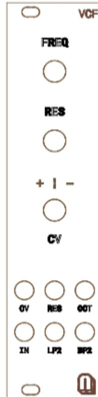
Figura 42 - Diseño del panel del VCF
