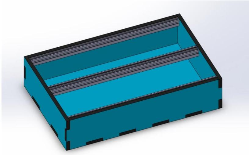
Figura 10 - Vista en Solidworks de la caja formato Eurorack.
