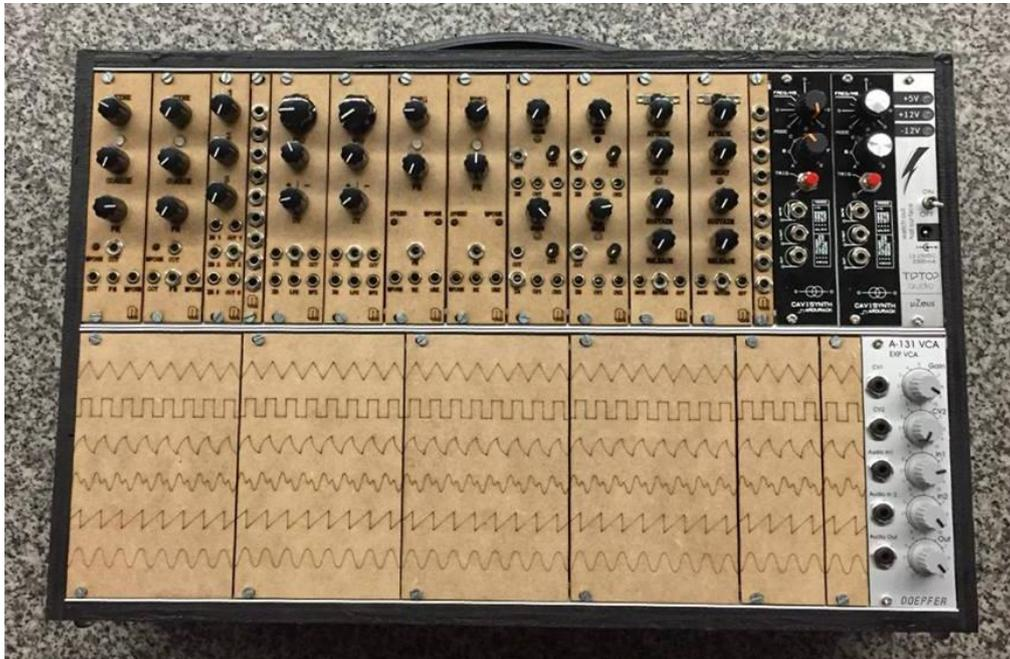
Figura 82 - Módulos montados en sus raíles
