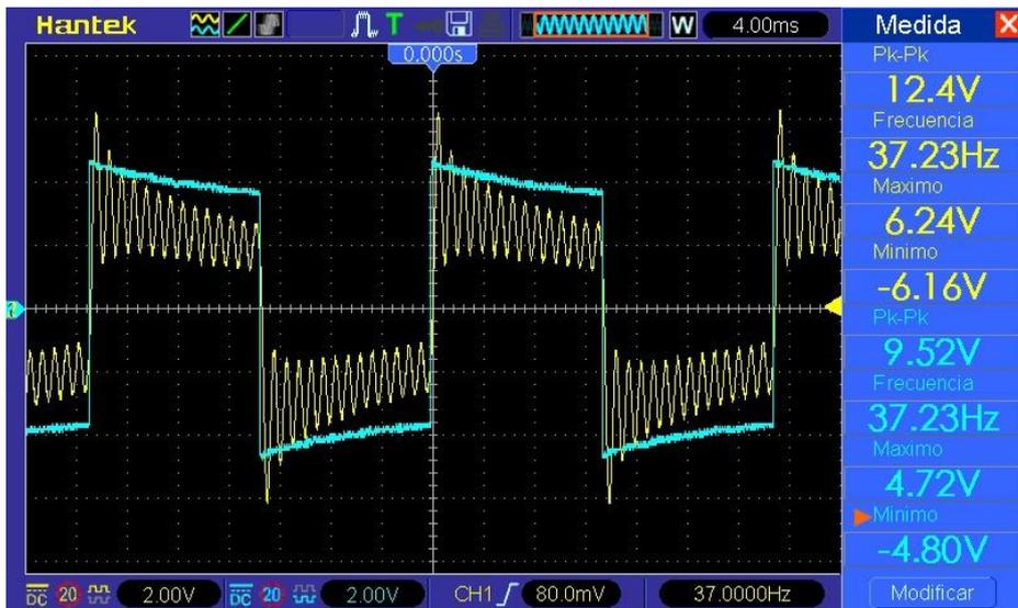
Figura 60 - VCF con frecuencia de corte a la mitad, resonancia alta, salida LP
