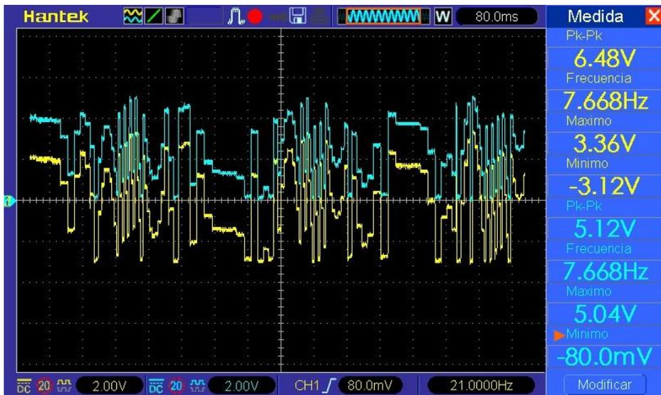
Figura 76 - Señal de salida del LFO ruido modulado en frecuencia
