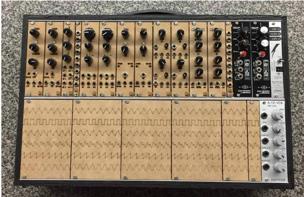
Figura 87 - Módulos montados en sus raíles
