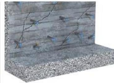
3. Ajuste la válvula antiretorno en el primer inyector y comience el proceso de inyección en la fila inferior de los taladros.
