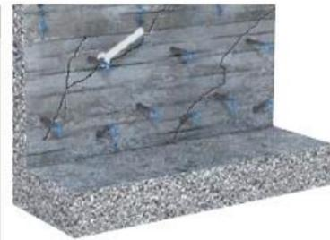
2. Instale los inyectores mecánicos. Ajuste los inyectores mecánicos de tal forma que resistan las máximas presiones de inyección.
