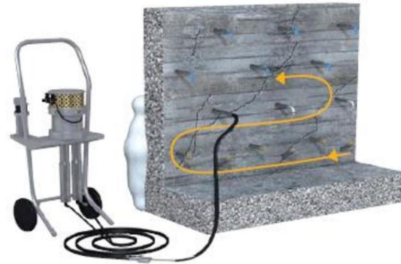
Ilustración 29. Secuencia de aplicación resina elástica de poliuretano. 2018. "SIKA"
