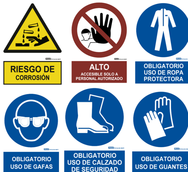
Figura 10. Señalización del almacenamiento de materias primas corrosivas. (Implaser, 2018).
