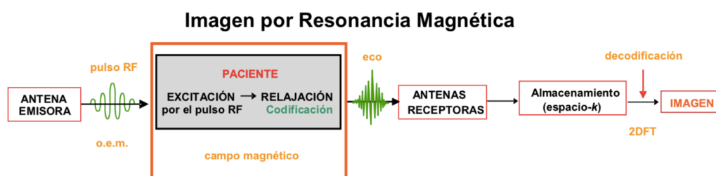
Figura 3. Esquema del procedimiento de obtención de una imagen por resonancia magnética (Moratal, 2017)
