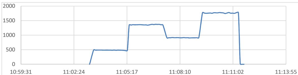
Gráfica 7-11. Ensayo ciclo del secador de pelo.
