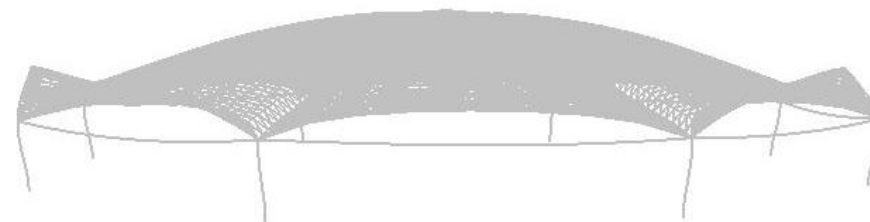
Imagen 54 Deformada HIP01: Peso Propio Architrave 2015 ©
