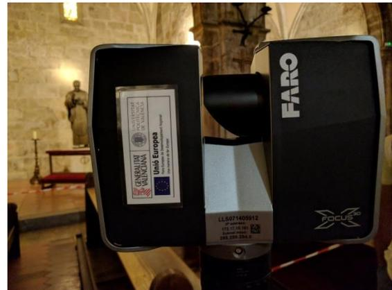
ILUSTRACIÓN 16- ESCÁNER LASER DURANTE EL ESCANEADO DE LA IGLESIA. FUENTE PROPIA
