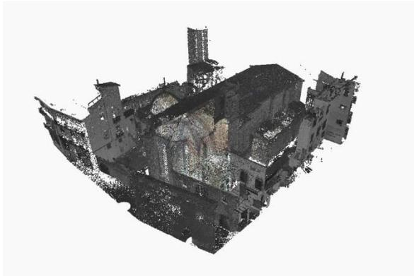
ILUSTRACIÓN 20- NUBE DE PUNTOS UNIFICADA
