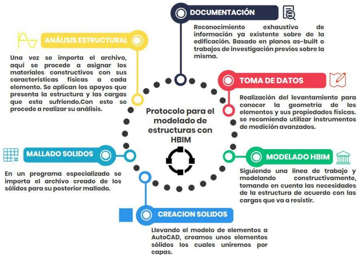
ILUSTRACIÓN 58- PROTOCOLO PARA EL MODELADO DE ESTRUCTURAS HBIM, REVISADO. FUENTE PROPIA
