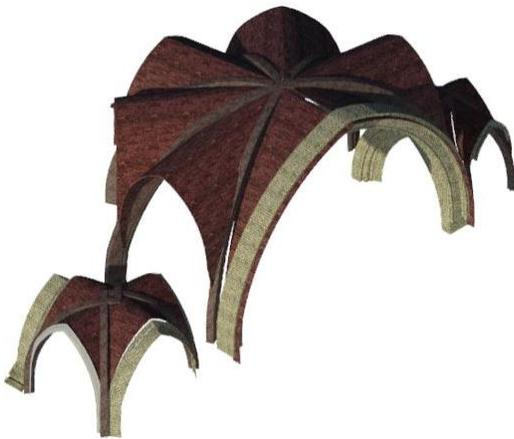
ILUSTRACIÓN 11- MODELO ÁBSIDE NERVIOS Y BÓVEDA
