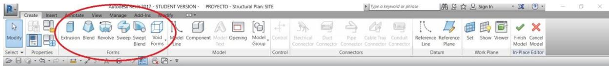
ILUSTRACIÓN 28- HERRAMIENTAS DE MODELADO IN SITU. FUENTE PROPIA
