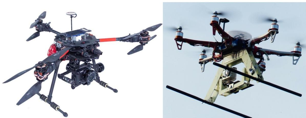
*Figura 2: Hexarotor en Y (izquierda), Hexarotor circular (derecha)*
