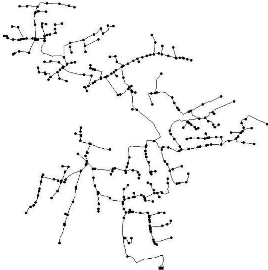
*Figura 4: Modelo hidráulico de la red original en Epanet*
