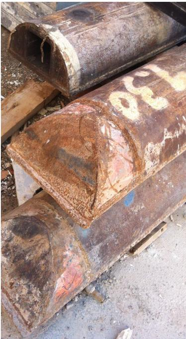
*Ilustración 20 Apoyo junta semicircular*
