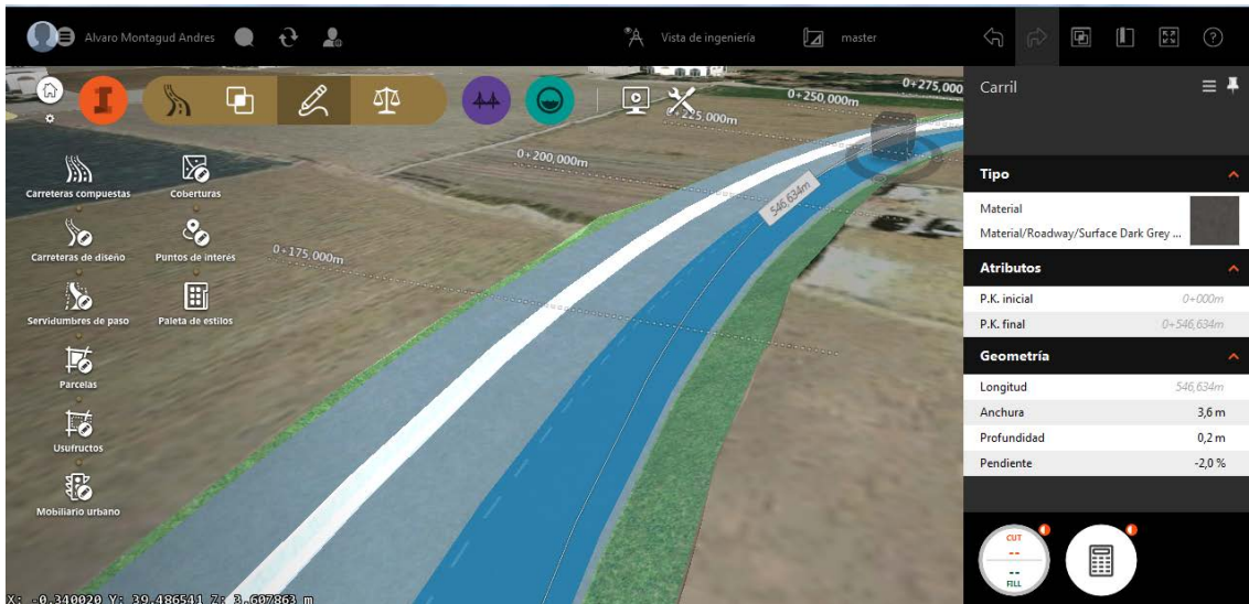
Ilustración 50. Ejemplo de un componente de carretera. El carril derecho está seleccionado y pueden modificarse tanto el material del que está hecho, su anchura, su profundidad y la pendiente. Fuente: (Infraworks, 2018).
