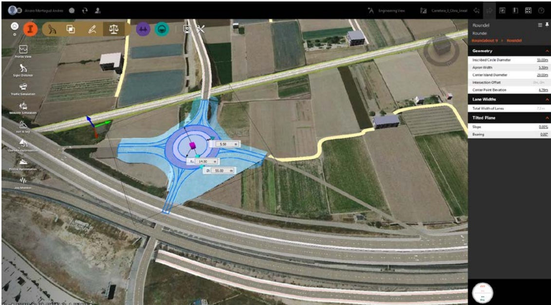
Ilustración 74. Localización de la glorieta para la conexión de la Patacona con la V-21. En la imagen se ven los parámetros hablados anteriormente. Fuente: (Infraworks, 2018).
