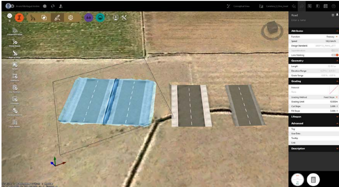
Ilustración 65. Imagen de los diseños de las carreteras. De izquierda a derecha: V-21, Av. MareNostrum y C. Camí a la Mar. A la derecha se puede ver la configuración para la V-21 como ejemplo (freeway, 100km/h, AASHTO). Fuente: (Infraworks, 2018).
