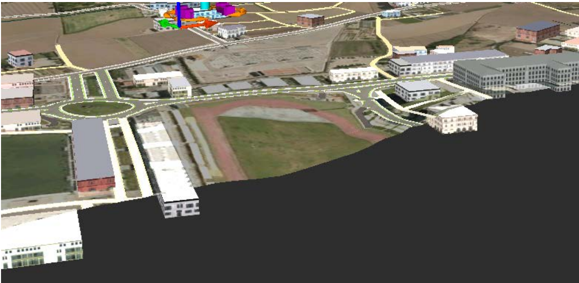
Ilustración 40. Imagen extraída del mismo Modelo ejemplo, donde se observa la generalidad del Modelo de elevaciones. Se nota que a la hora de obtener el MDE se ha tomado todo en su conjunto (Terreno y Superficie), dejándolo poco viable para zonas Urbanizadas o de cambios grandes de altitud, ya que la resolución suaviza dichos cambios. Fuente: (Infraworks, 2018).
