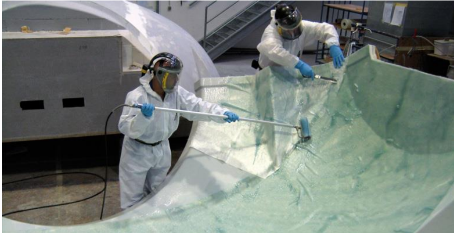
Figura I.12. Operarios realizando el proceso de conformado de moldeo manual. 15
