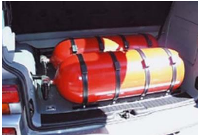
Figura III.42. Depósitos con sus correspondientes correas de fijación.
