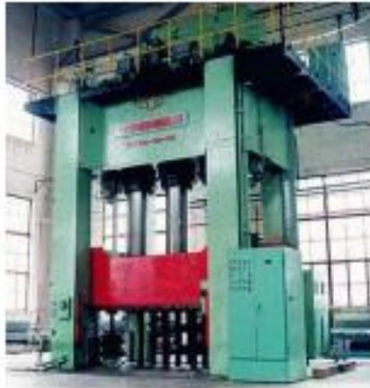
Figura I.16. Representación del proceso moldeo por compresión en caliente de un preimpregnado. 19
