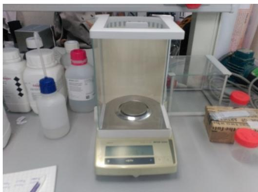
**Figura 3.3.** Balanza usada para medir la masa de las muestras.
