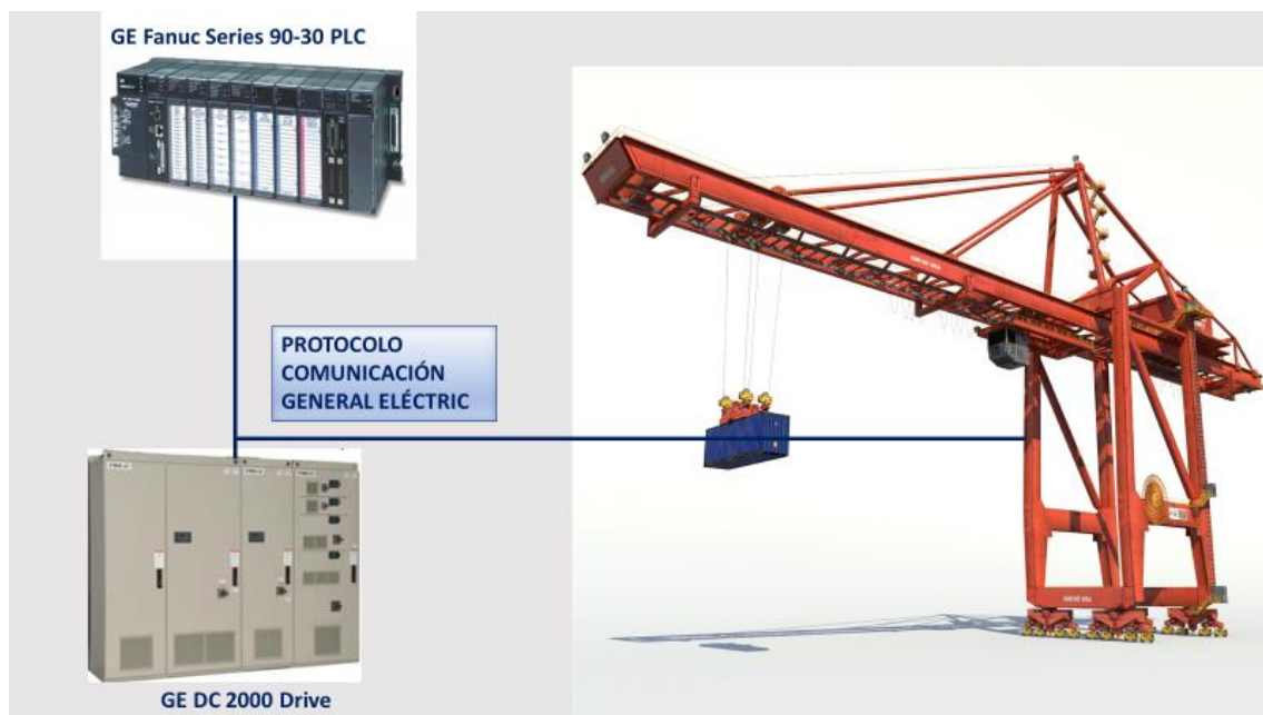
Ilustración 15- Sistema de control actual de la grúa
