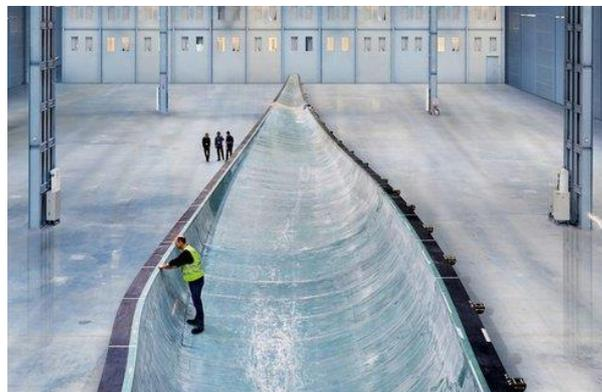
Figura III.76. <sup>xxiii</sup> Molde abierto en el que se aplican los procesos descritos anteriormente.
