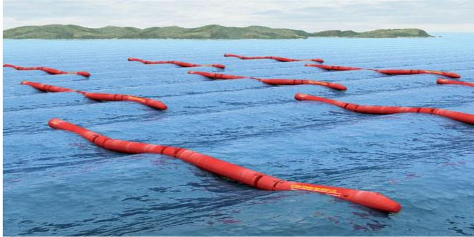
**Figura I.8.** <sup>viii</sup>El movimiento de las olas accionan las bombas hidráulicas ubicadas en el interior de los cilindros.
