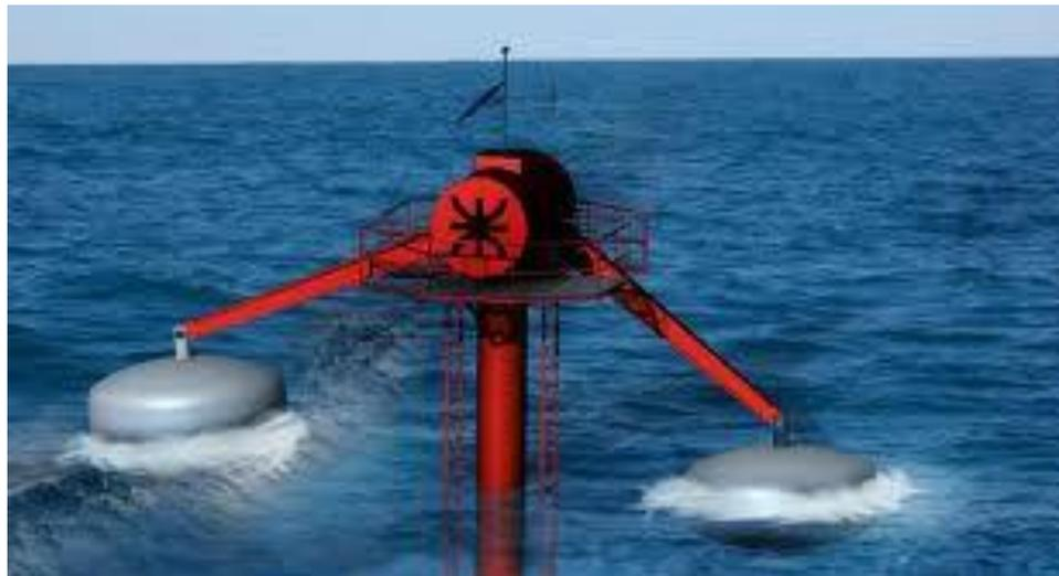
**Figura I.9.** <sup>ix</sup>Aparato flotante de partes articuladas que obtiene energía del movimiento relativo entre ambas partes.
