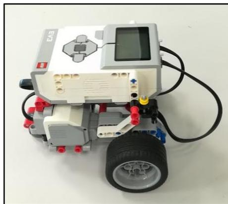
Figura 14. Configuración diferencial
