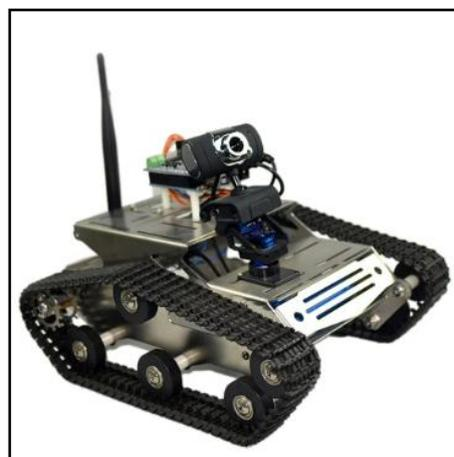
Figura 15. Configuración oruga
