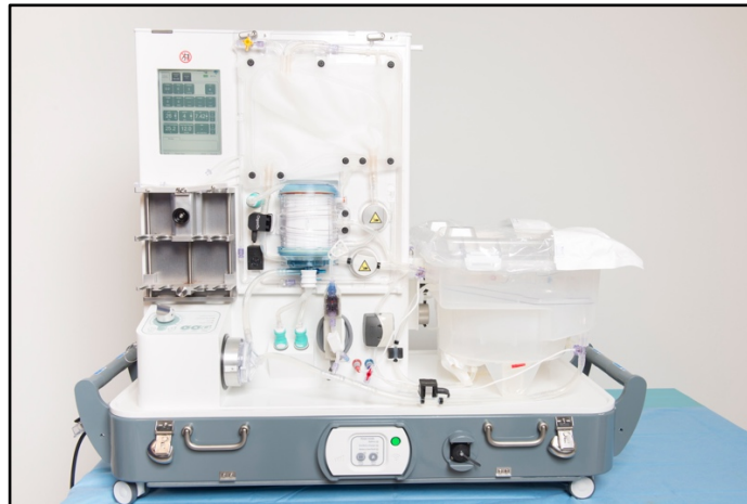
Figura 22: Dispositivo OrganOx metra tras ensamblar el circuito. Preparado para el cebado.
