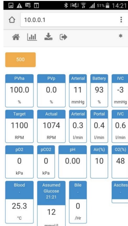
Figura 25: Smartphone con pantalla remota del dispositivo OrganOx metra
