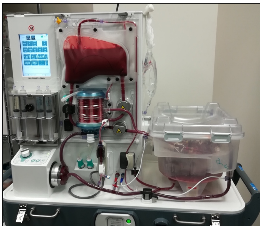
Figura 38: Montaje completo del sistema OrganOx metra preparada para comenzar la perfusión
