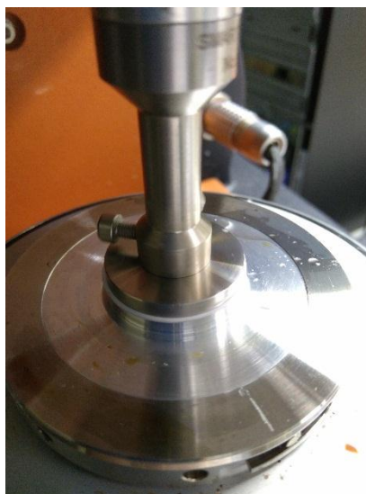
Figura 6: Componentes del reómetro donde se puede observar el plato inferior en el cual se coloca la muestra y el plato superior y el brazo
