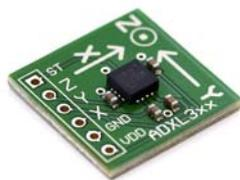
Fig. 120 Acelerómetro ADXL 330, en (Seidle, 2006)
