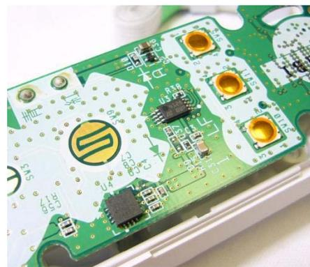
Fig. 123 Acelerómetro y EEPROM, en (Seidle, 2006)
