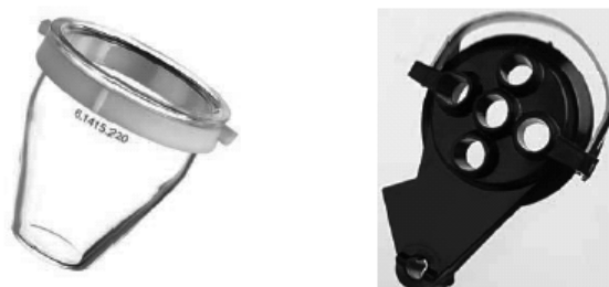
Fig. 6.11. Célula electroquímica y dispositivo de cierre y sujeción en las experiencias voltamétricas.
