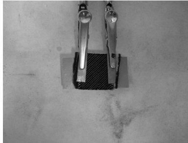
Fig. 6.3. Imagen donde se muestra el sistema de medida de resistividad superficial mediante espectroscopía de impedancia electroquímica.
