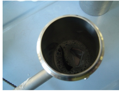
Fig. 6. 20. Imágenes donde se presenta: a) linitest, b) muestras para realizar ensayo de lavado, c) interior del linitest, d) probeta con la muestra y el detergente.
