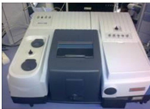
Fig. 6.6. Espectrómetro FTIR Nicolet 6700 con detector DTGS.
