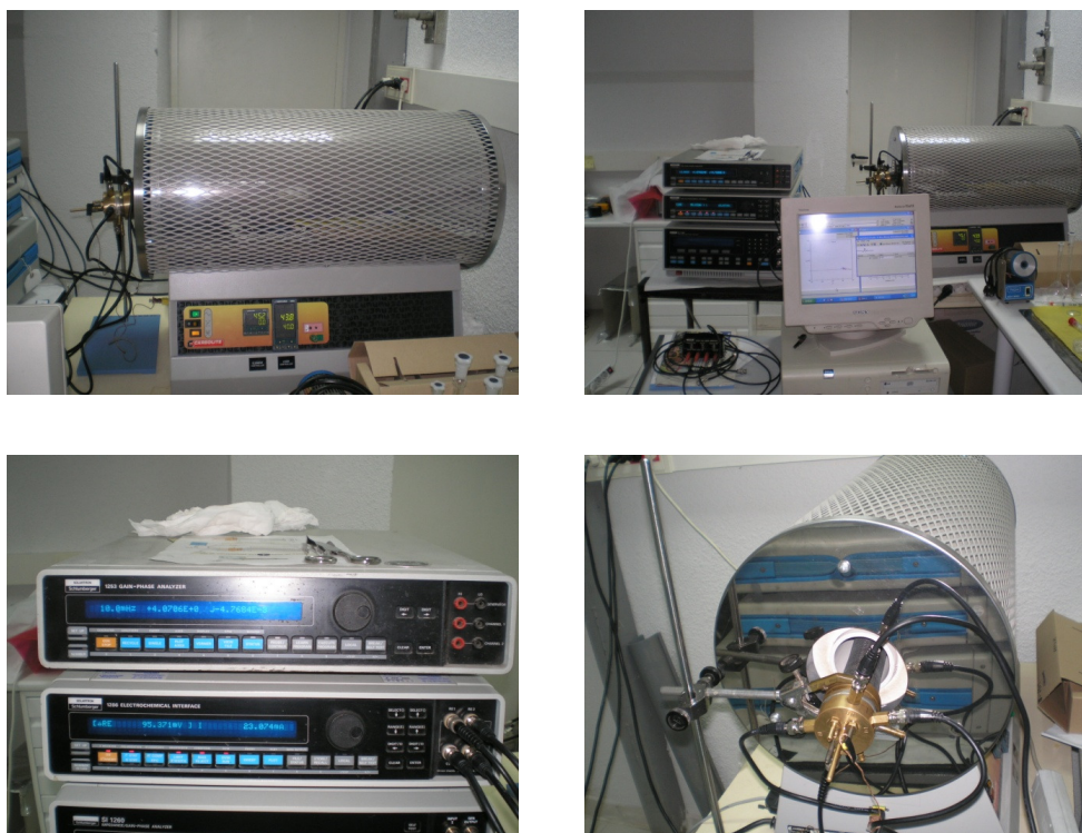
Fig. 6.14. Imágenes del montaje para realizar medidas de impedancia con la temperatura.
