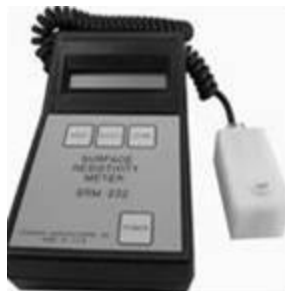
Figura 6.1. Resistímetro modelo SRM-232-2000 (Guardian Manufacturing) para medidas de resistividades superficiales 0-2000 \Omega/\square .
