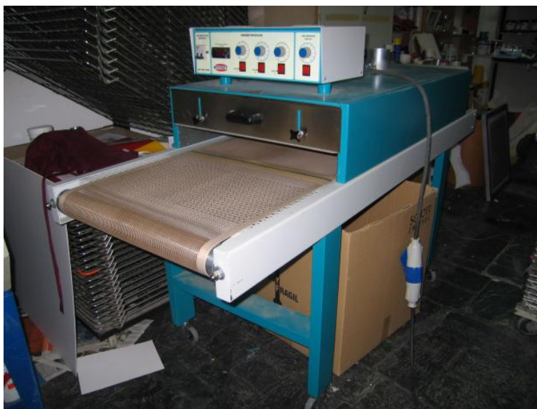
Ilustración 19: Túnel de secado jet set 600.
