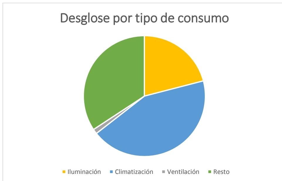
Figura 18. Desglose energético durante el periodo de refrigeración
