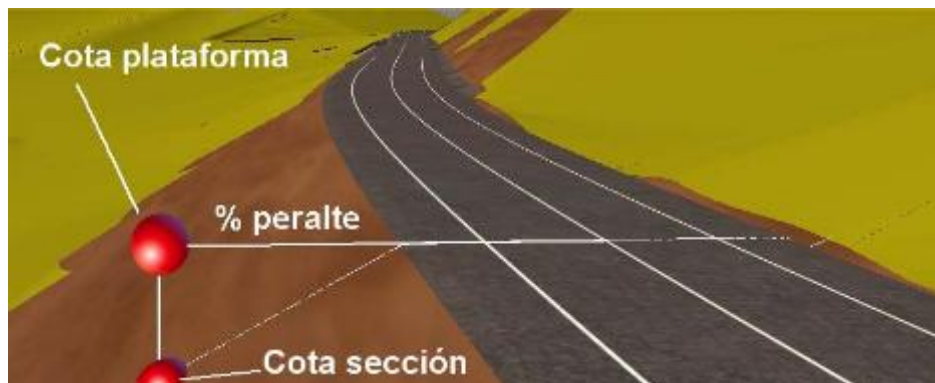
Figura 22: Sección de carretera
