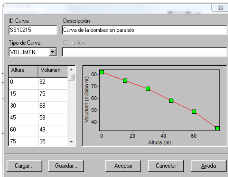
Ilustración 25: Curva de la bomba ajustada y definida mediante varios puntos
