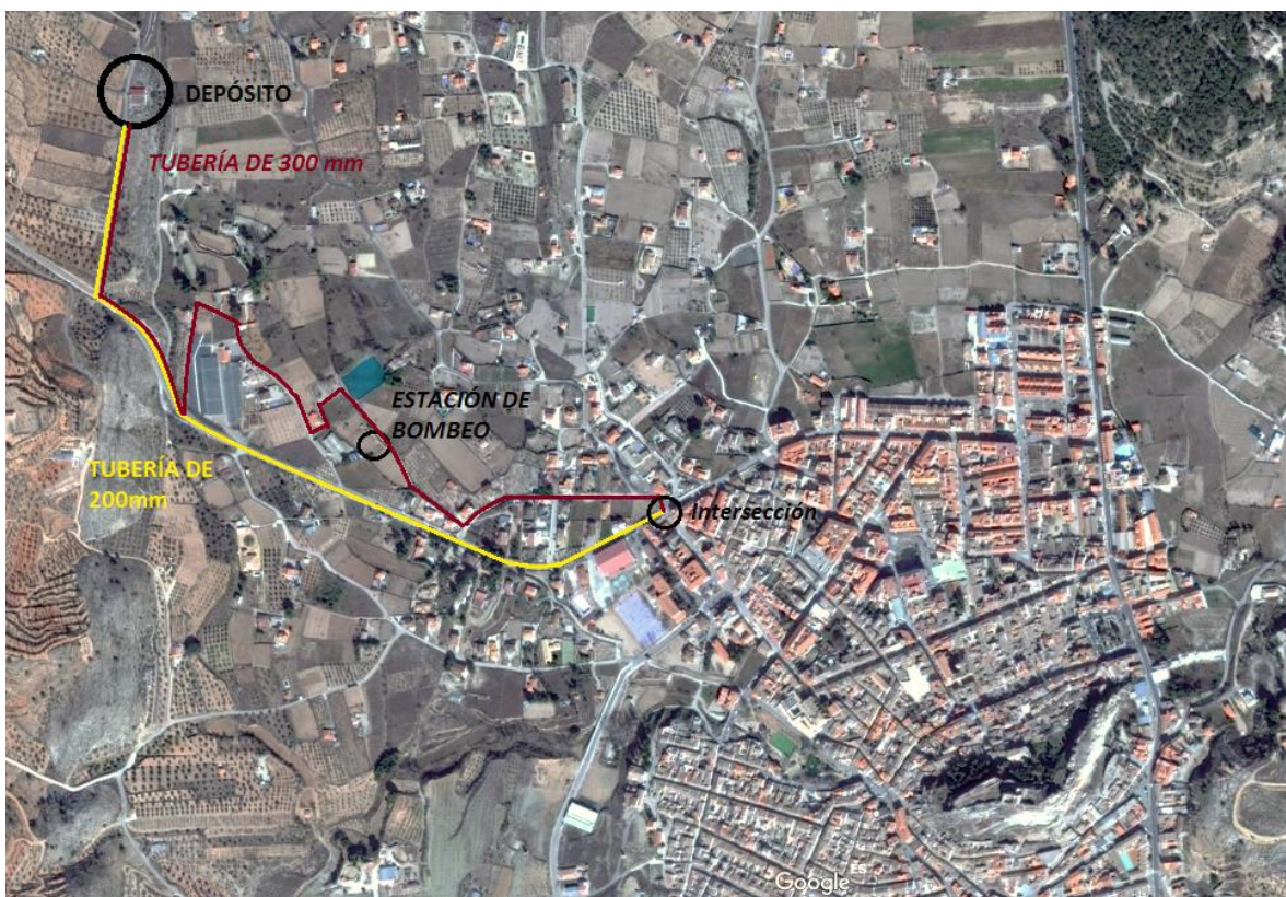
Ilustración 7: Esquema de conexión del depósito con el pueblo
