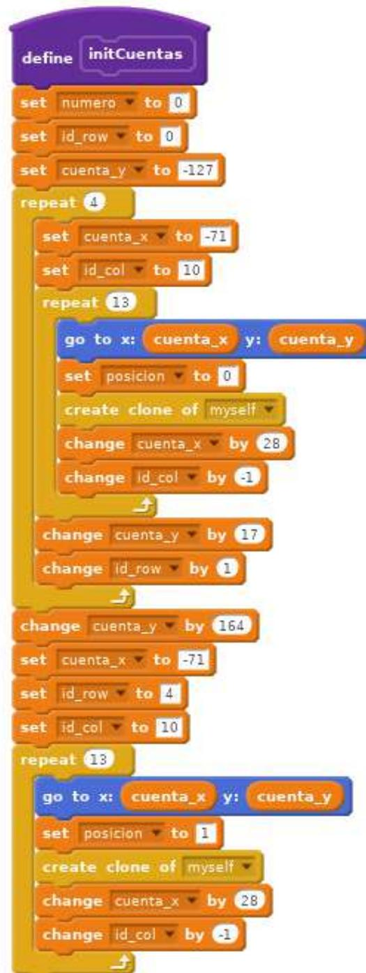
**Figura 4.8:** Fragmento de código del *soroban*, construido en un bloque o subrutina separado llamado **initCuentas**, y encargado de la inicialización de todas las cuentas del ábaco en sus posiciones iniciales y con valores correctos en sus variables locales (**id\_row**, **id\_col** y **posicion**), que serán necesarias posteriormente
