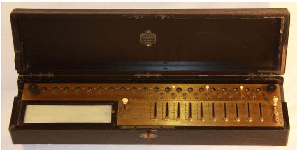
**Figura 2.6:** Aritmómetro de Thomas de Colmar. Como puede observarse, la mayor diferencia con respecto a su antecesora creada por Leibniz es la elegancia y estética del Aritmómetro, al estar éste orientado a la venta al público, mientras que la construcción de la máquina de Leibniz solo respondía a una motivación de curiosidad científica.
