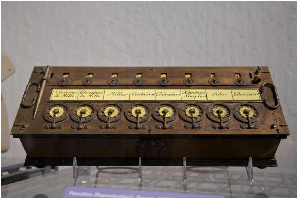
**Figura 2.4:** Una reproducción de la Pascalina de Blaise Pascal. Pueden observarse los mecanismos de entrada de datos a través de las ruedas de la parte inferior, así como la representación del resultado en los pequeños agujeros de la parte superior.
