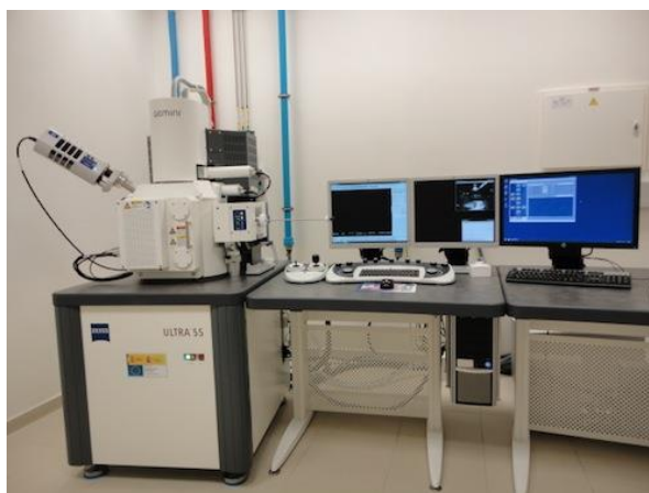
Figura 7. Microscopio Electrónico de Barrido de Emisión de Campo (FESEM). Marca Zeiss , fabricante Zeiss Oxford Instruments .
