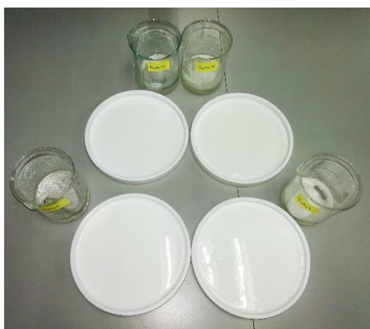
Figura 5. Placas de teflón con el material encapsulante en proceso de secado durante 48h.
