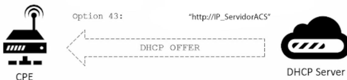
Figura 24 - DHCP OFFER devolviendo la dirección del Servidor ACS
