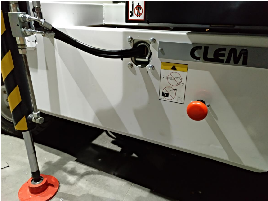
Figura 7.7. Emplazamiento del pulsador paro de emergencia principal.
