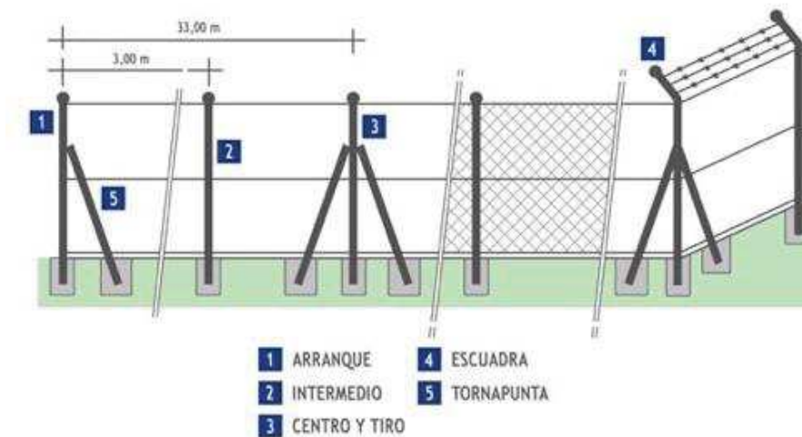
26. DETALLES VALLA DE SIMPLE TORSIÓN
