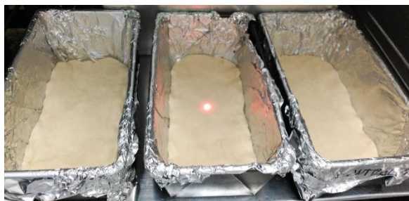
Figura 4. Puntero láser con el que se determinó la capacidad fermentativa de las masas.
