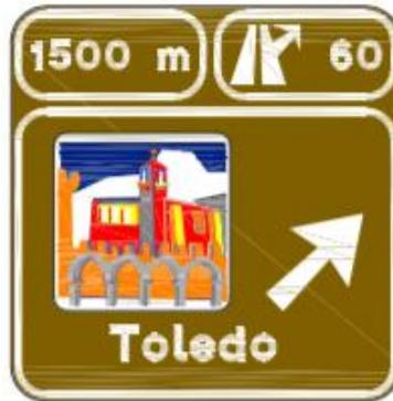
Ilustración 20. Señal vertical de punto de interés (Fuente. Norma 8.1-IC)
