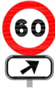
*Ilustración 19. Señal vertical R-301 con panel complementario (Fuente: Norma 8.1-IC)*
