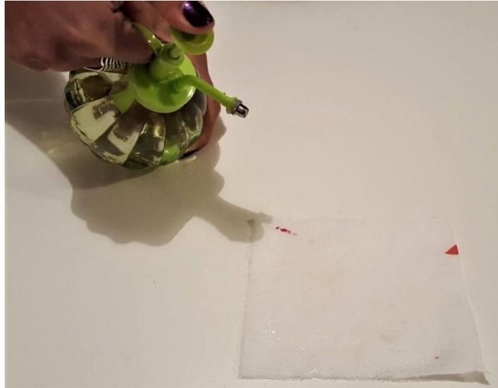
Figura 4.10. *Pulverización de las microcápsulas sobre la probeta del ensayo*
