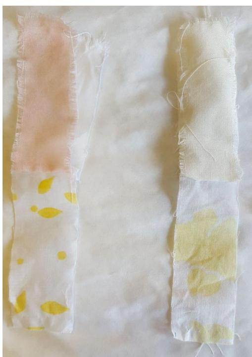
Figura 5.18. Resultado de degradación total de la probeta amarilla
