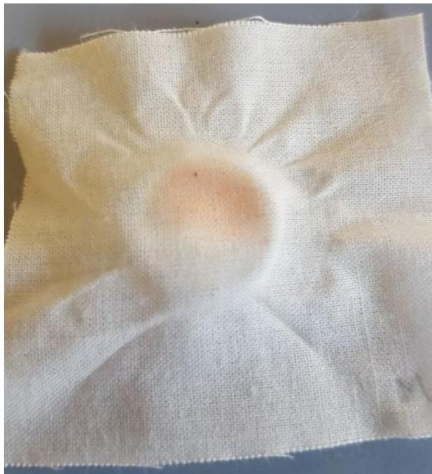
Figura 5.12. Resultado de la descarga sobre la probeta de mezcla en húmedo
