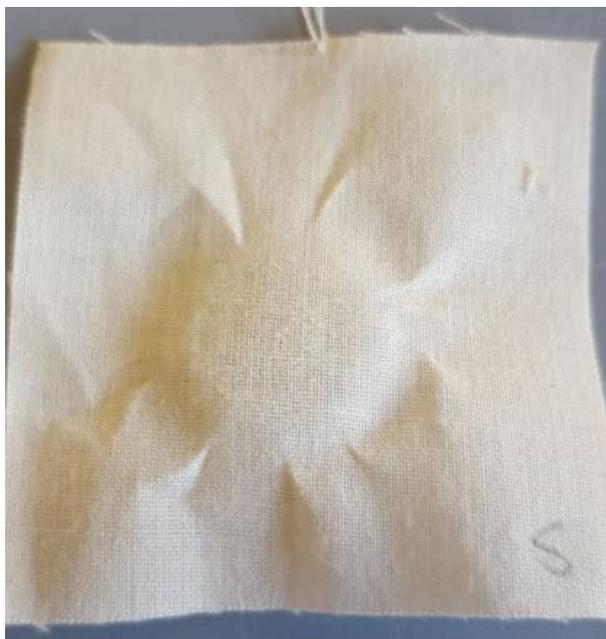
Figura 5.9. Resultado de la descarga sobre la probeta de cúrcuma en seco
