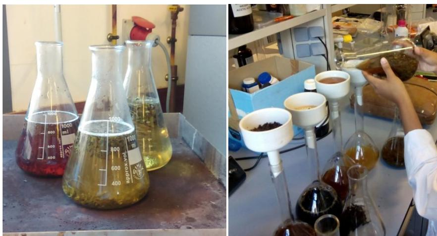
Figura 4.1. Ebullición del té y posterior filtración de los posos
