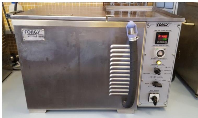
Figura 5.17. Equipo ensayo solidez lavado
