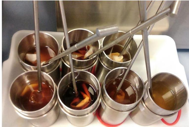
Figura 4.3. Preparación de las muestras para el proceso de tintura
