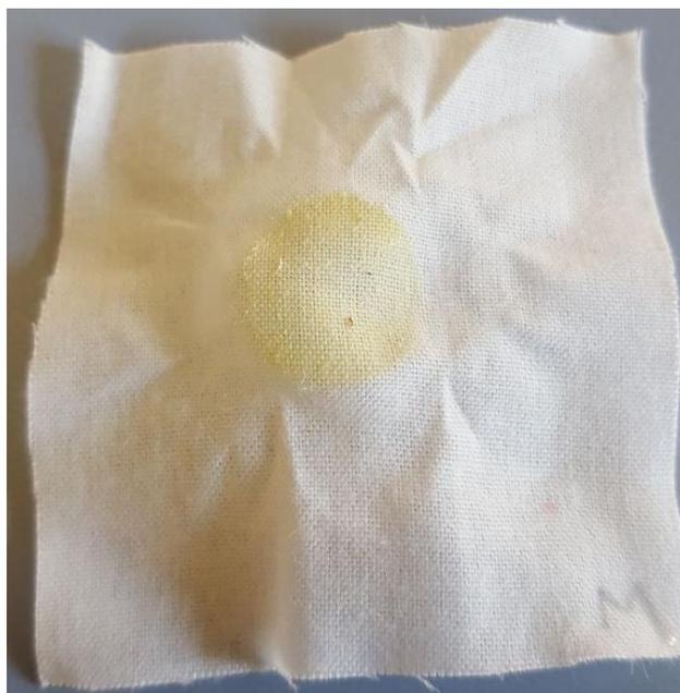
Figura 5.10. Resultado de la descarga sobre la probeta de cúrcuma en mojado
