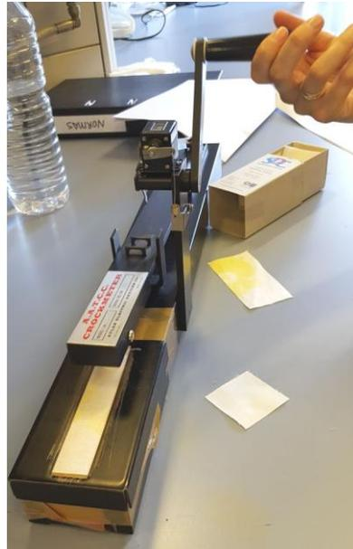
Figura 5.8. *Ensayo de la probeta de cúrcuma en húmedo*
