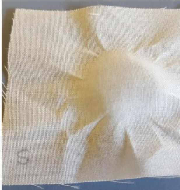
Figura 5.11. Resultado de la descarga sobre la probeta de mezcla en seco
