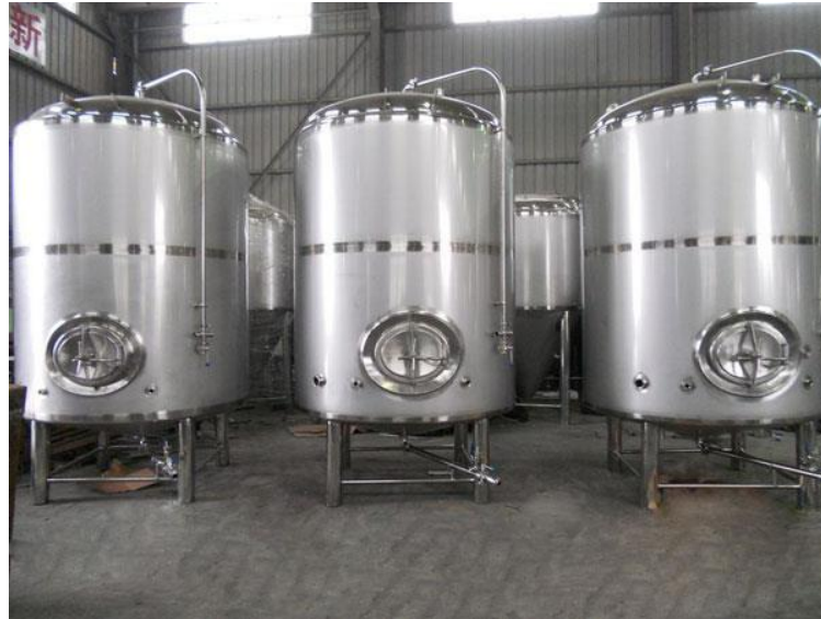
Figura 6. Tanques de maceración.
